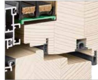
Doppelfalzkonstruktion mit zusätzlicher, dauerhaft geschützter Mitteldichtung: bessere Dichtheit, höhere Wärmedämmung und Schalldämmung.
