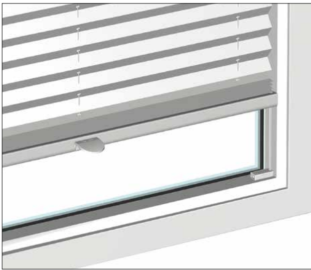
Montagemöglichkeit in die Glasleiste mit Spannschuhen.
